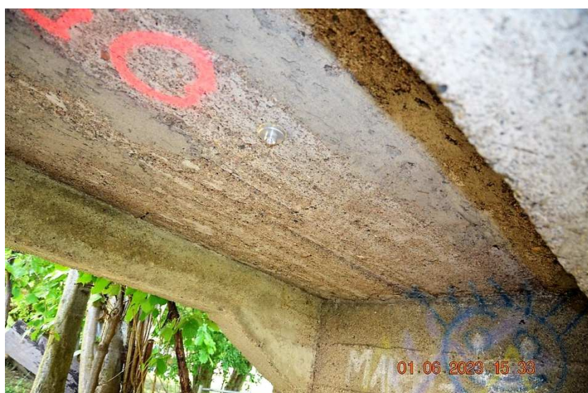
Odtrhová zkouška 5 ve 4. poli na podhledu.
