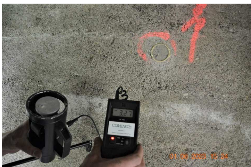
Odtrhová zkouška 1 na opěře 4 ve 4. poli – výsledek 3,27 MPa.
