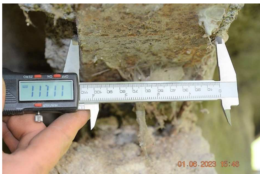
Pata zabetonované kolejnice.
