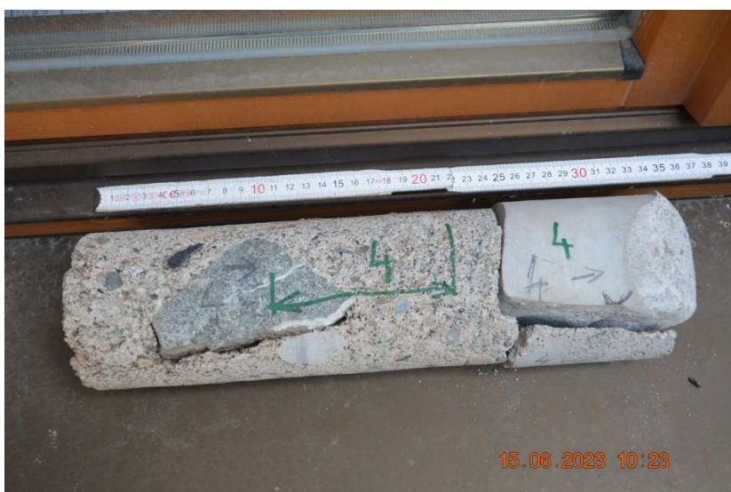
Vývrt 4 D 100 mm z opěry 6 v 6. poli, velké zrno ovlivnilo hodnotu pevnosti betonu v tlaku směrem nahoru.
