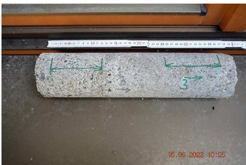
Vývrt 3 D 100 mm z opěry 4 ve 4. poli.
