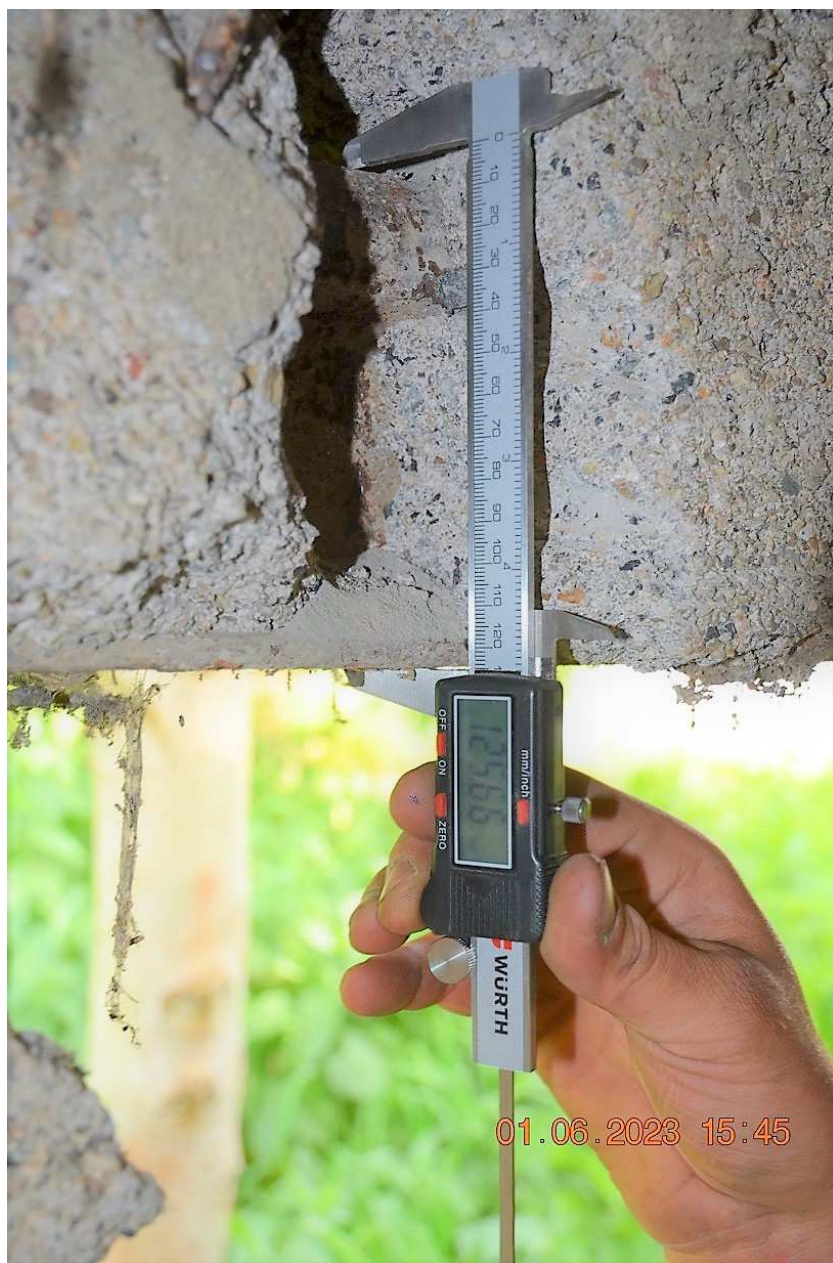
Výška zabetonované kolejnice.
