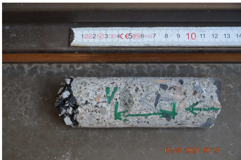
Jádro V1 D 50 mm z podhledu včetně vozovky..
