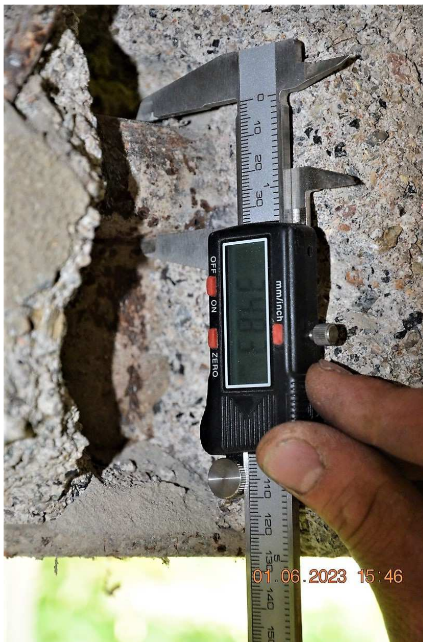
Výška hlavy zabetonované kolejnice.
