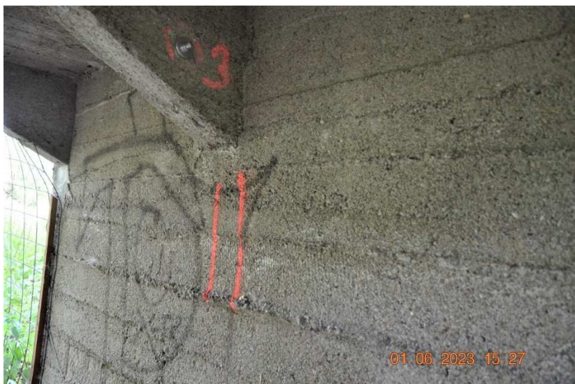
Odtrhová zkouška 3 na náběhu trámy ve 4. poli.
