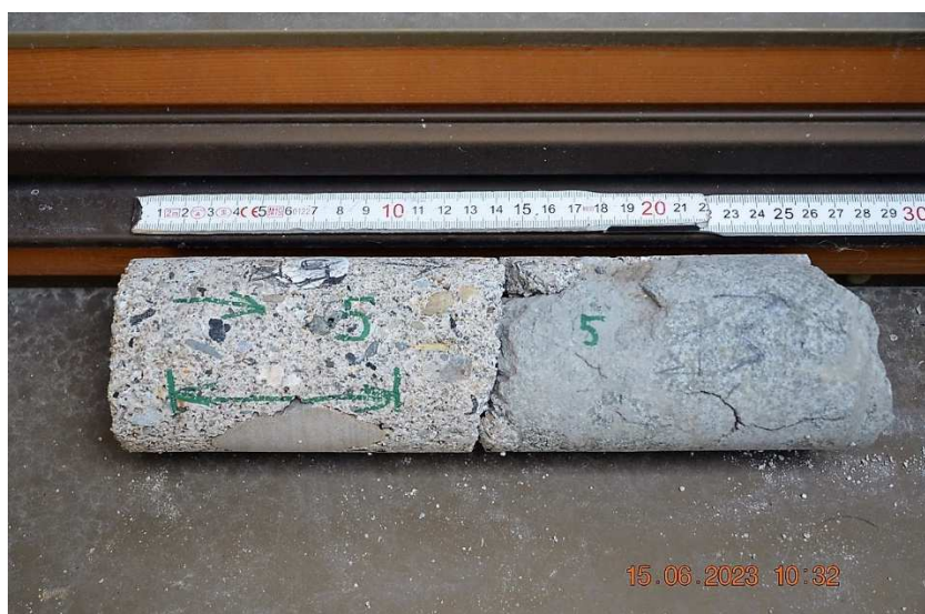
Vývrt 5 D 75 mm s velkými zrny z levého boku podpěry 7.
