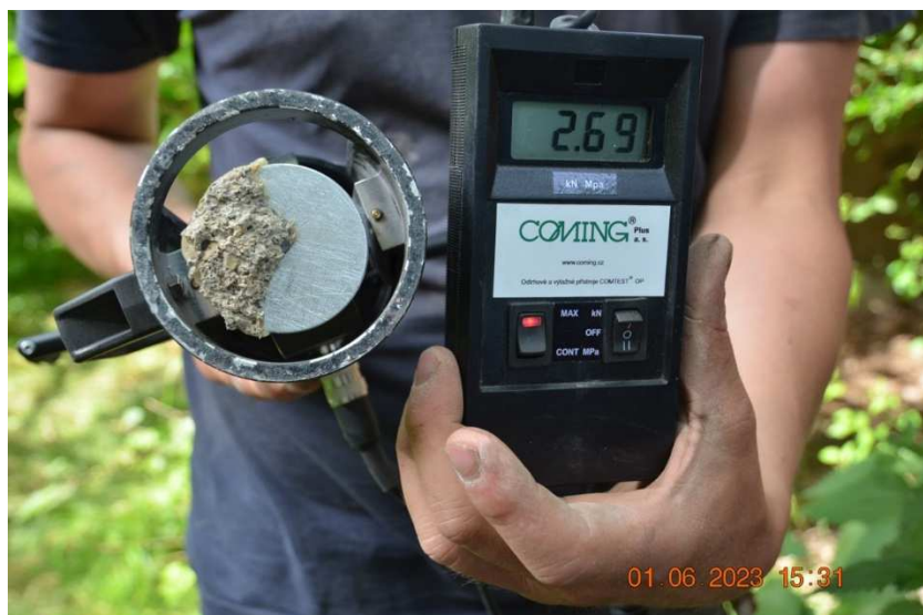
Výsledek odtrhové zkoušky 4 na boku opěry 5 vlevo – 2,69 MPa.
