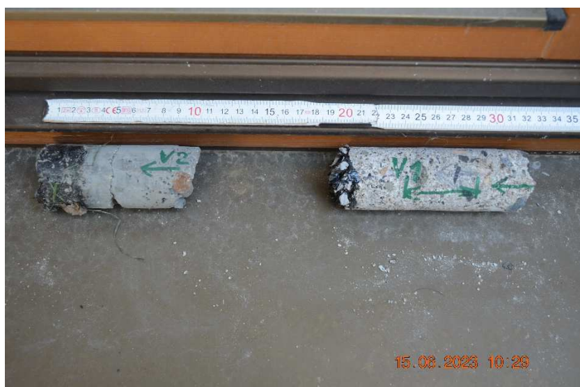
Jádra V1 a V2 D 50 mm z podhledu desky.
