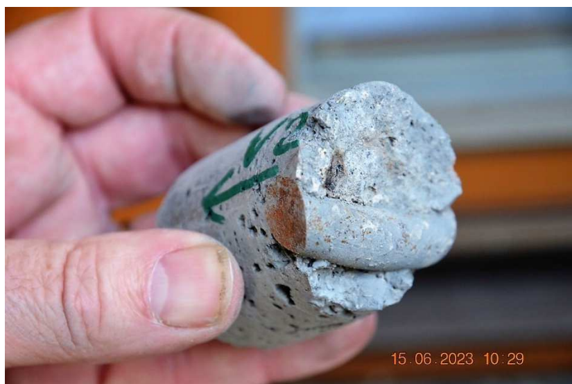
Jádro V2 S 50 mm vrtané přes výztuž D=12mm.
