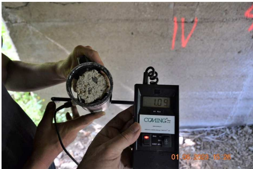
Odtrhová zkouška 2 na podhledu nosné konstrukce ve 4. poli – výsledek 1,09 MPa.
