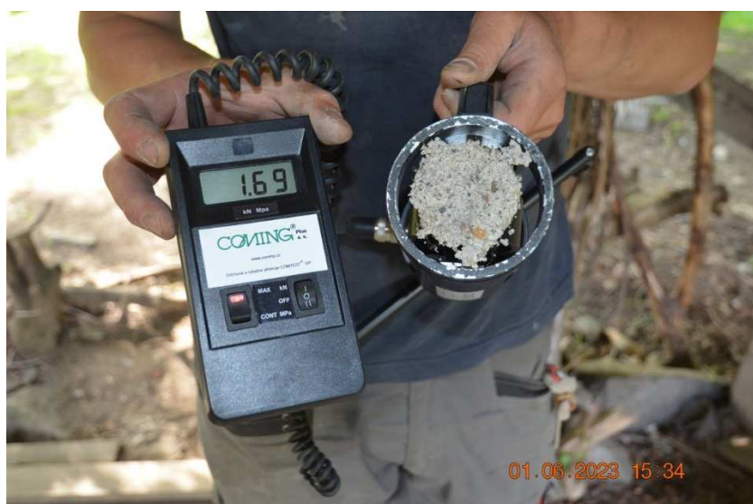
Odtrhová zkouška 5 ve 4. poli na podhledu – výsledek 1,69 MPa.
