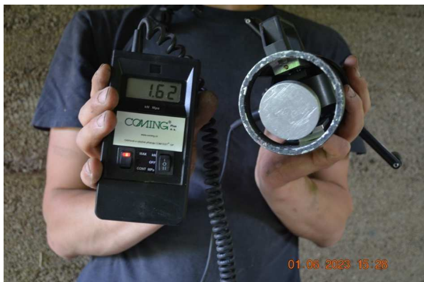
Odtrhová zkouška 3 na náběhu trámu ve 4. poli – výsledek 1,62 MPa.
