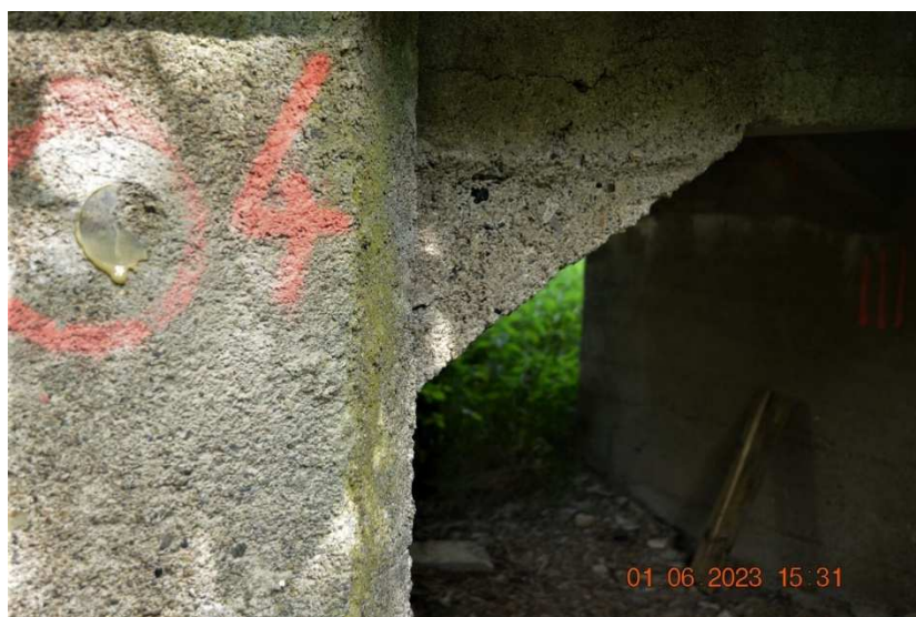
Detail odtrhové zkoušky 4 na boku opěry 5 vlevo – ze 60 % zůstalo lepidlo na betonu.
