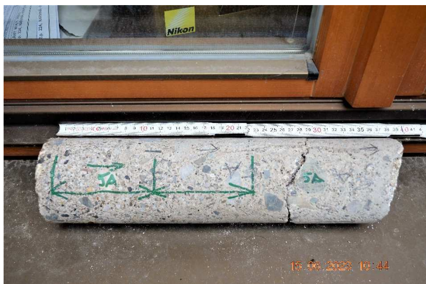
Vývrt 5 D 100 mm z levého boku podpěry 7.
