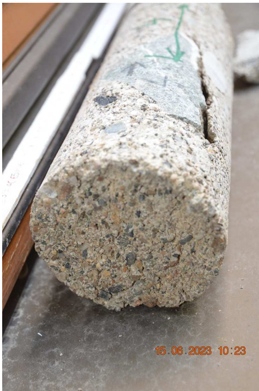
Vývrt 4 D 100 mm – kamenivo nemá jemný tmel a nelze provádět nedestruktivní zkoušky Schmidovým kladívkem.
