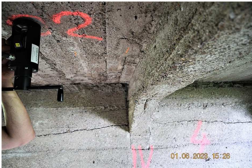
Odtrhová zkouška 2 na podhledu nosné konstrukce ve 4. poli.
